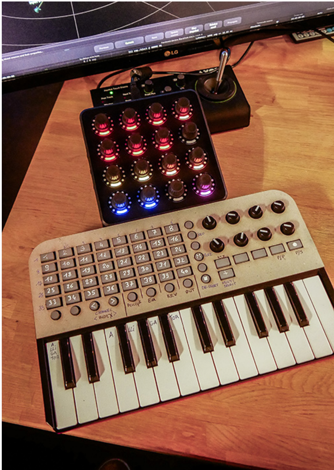
SPAT et les commandes JL Cooper Axos, Midi Fighter et Akai APC Key, interfacés avec le logiciel Chataigne
