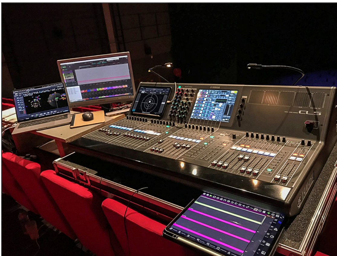
Régie théâtre en mode immersif, console CL5, logiciels Reaper et SPAT.
